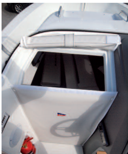
Die Persenningabdeckung soll einem festen Steckschott weichen.
