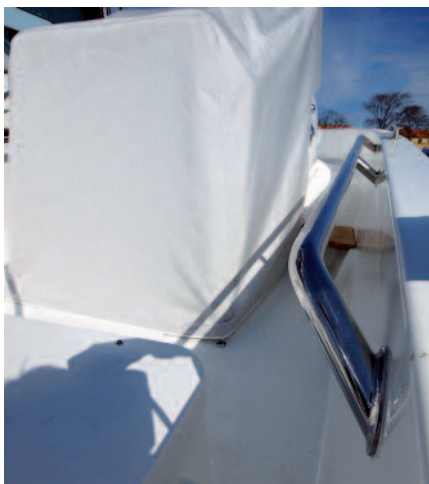
Schwedenstahl: Beschläge, Handläufe und Festmacherklampen sind gut dimensioniert und sauber verarbeitet.
