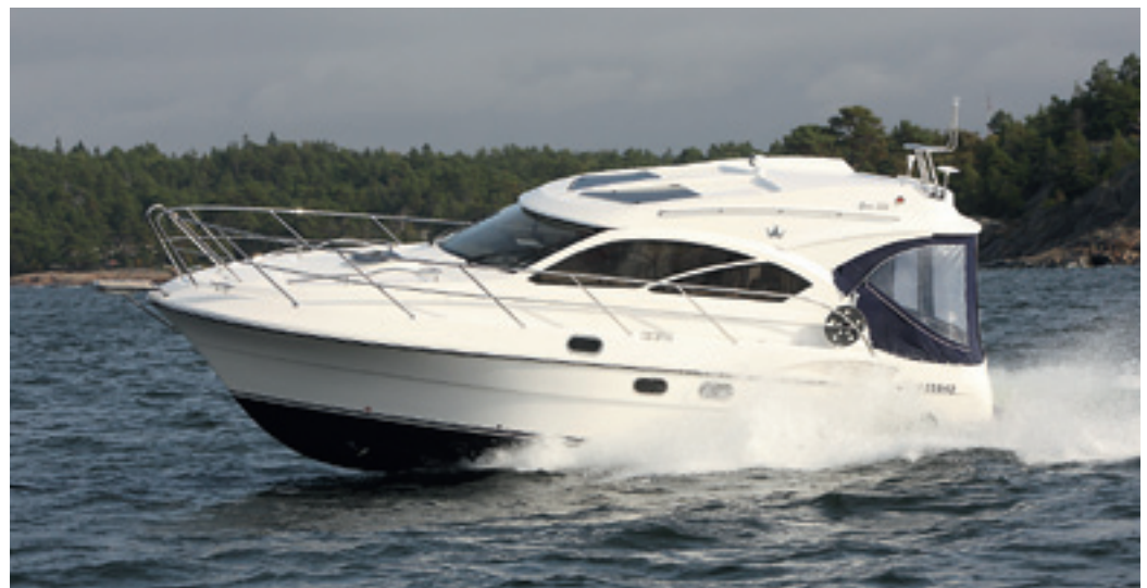
Trimmitasojen asennolla on suuri merkitys Skorgenesin nopeuteen. Vene kulkee paremmin trimmille- vyt selvästi laskettuna, matkanopeuksilla ero on jopa kahden solmun luokkaa. Melutaso on kokonaisuutena hyväksyttävällä tasolla, mutta polttoainetta kuluu reilusti.
