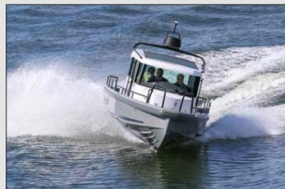
Den an ein RIB erinnernde Rumpf mit tiefem V-Schnitt und drei Kimmkanten zeichnet eine hohe Steifheit aus. Er ist derart gut gelungen, dass das Fahren auch bei Höchstgeschwindigkeit – 80 km/h – ein pures Vergnügen ist. Auf allen Kursen – auch in Kurven und beim Wellenkreuzen – fährt die Axopar äusserst stabil und reagiert zugleich fein auf Steuerimpulse. Auch Einsteiger werden das Boot problemlos beherrschen, ein Bugstrahlruder unterstützt Hafenmanöver.
